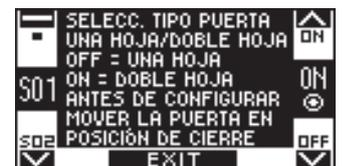
Seleccionar ON si está presente una cerradura eléctrica. Si la puerta carece de cerradura eléctrica mantener OFF.
