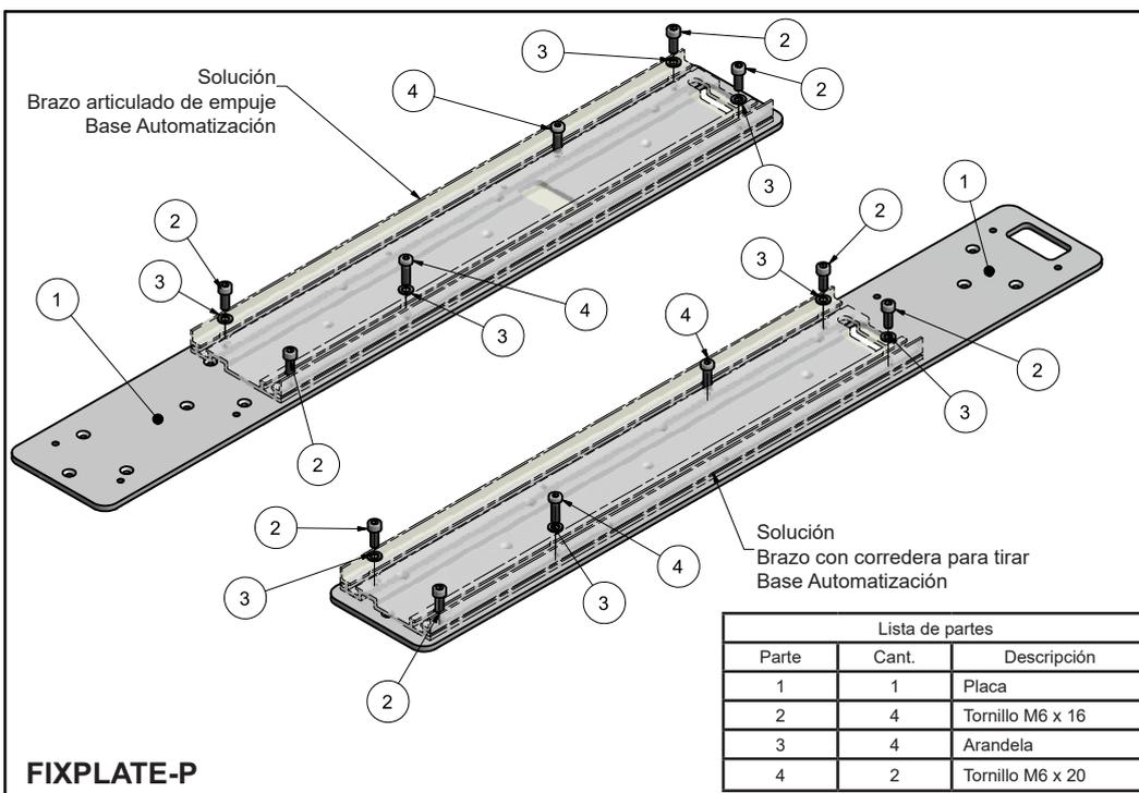
5.1) MONTAJE AUTOMATIZACIÓN EN EL DINTEL DESDE EL LADO DE LAS BISAGRAS
