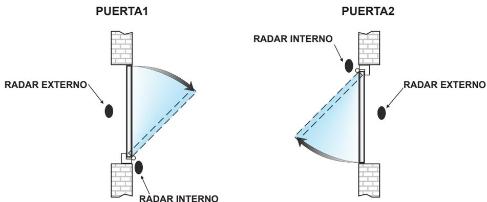
Se usan radares internos independientes para cada puerta cuando la distancia entre las dos puertas es tal que no hay interferencias en el campo de detección de los radares internos.
