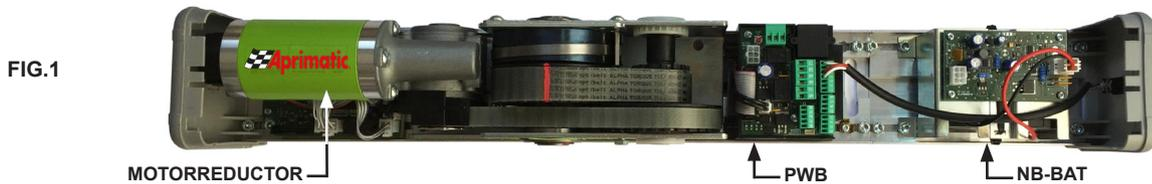
Con brazo articulado de empujar BSS2 y con brazo de corredera de empujar BDS, el módulo NB-BAT debe encontrarse al lado del motorreductor (FIG. 2).
