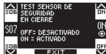
Solo si la función S06 se ha configurado en ON
